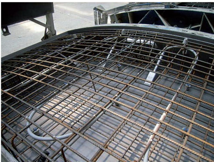
Bild 8: Absorberrohre mit Bewehrungskorb in einer Stahlschalung für die Tübbingbetonage
